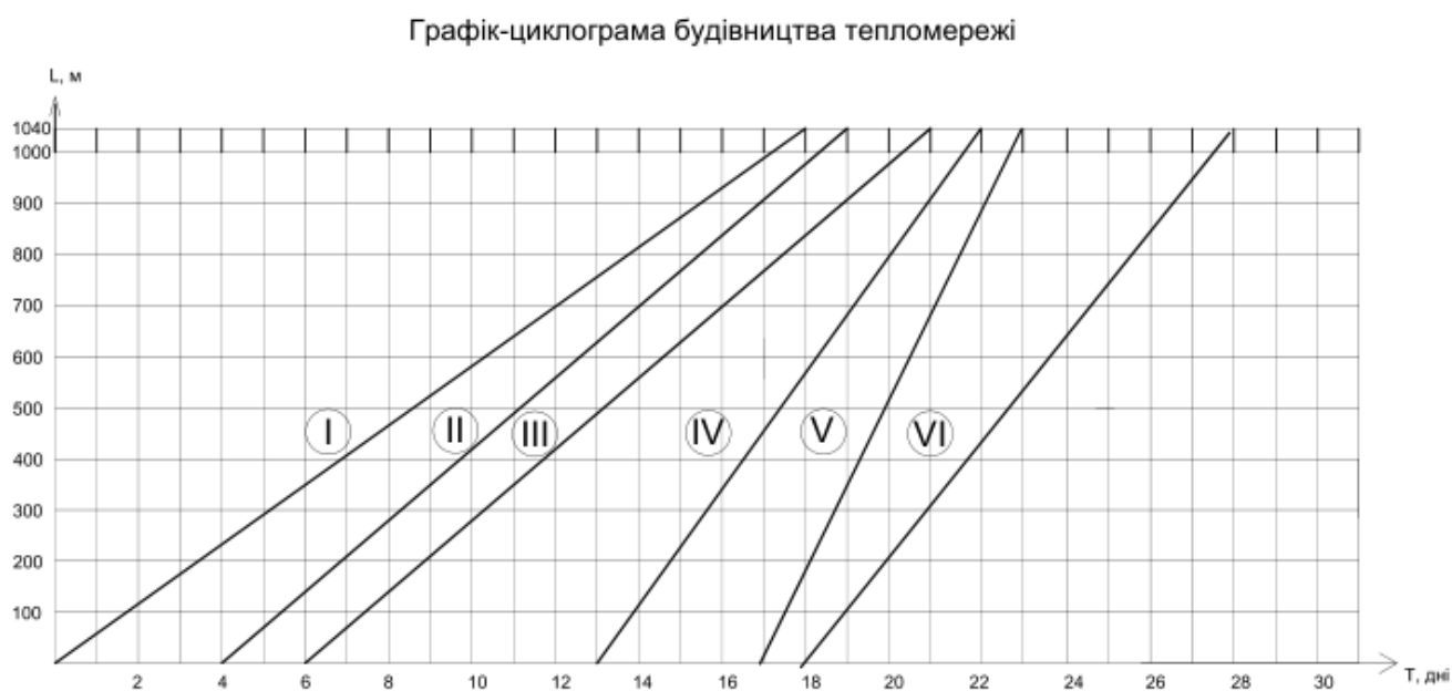
Рис.6.1 Графік-циклограма монтажу тепlopостачання виробничих приміщень
