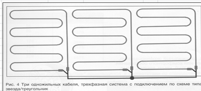
подключается к терморегулятору devireg® через контактор. При этом может использоваться схема звезда/треугольник. При напряжении 380 В необходимо использовать кабели, специально рассчитанные под 380 В.
