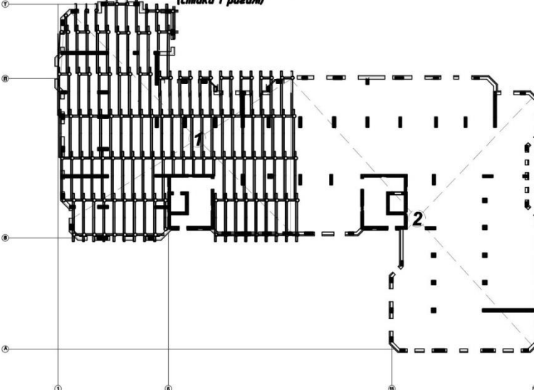
Схема установки опалубки перекрытия (стійки і ригелі)
