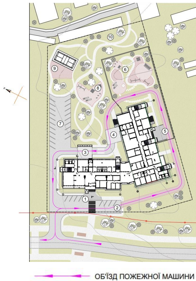
Рис.8.2. Схема об'їзду пожежної машини
