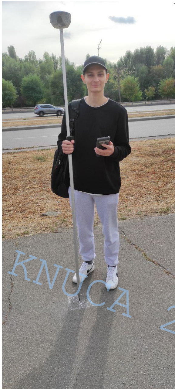
Рис. 2.3 Процес отримання координат контрольних точок ГНСС-методом
