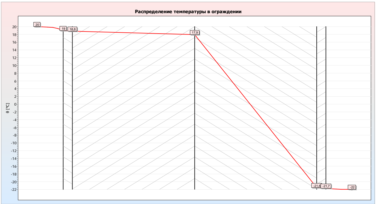
Рис.2.2. Розподіл температур в зовнішній стіні [7,8]
