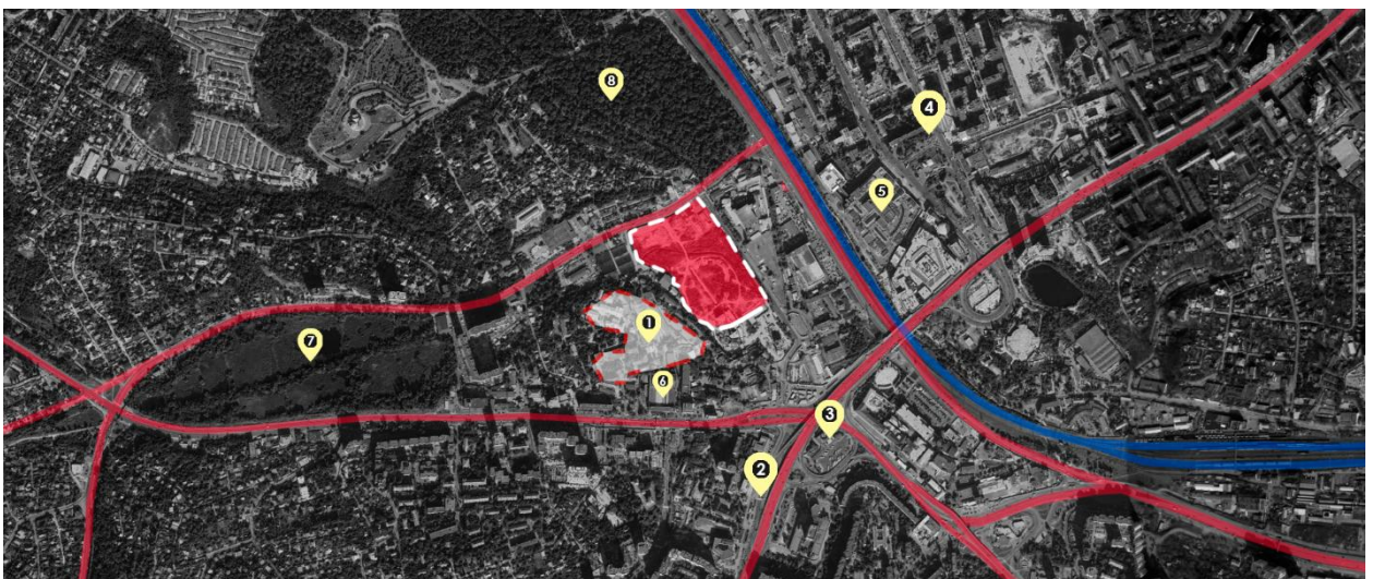
Рис. 5.2. Схема розташування транспортних шляхів (синім показано залізничні шляхи, червоним – автомобільні дороги) [розроблено автором]
