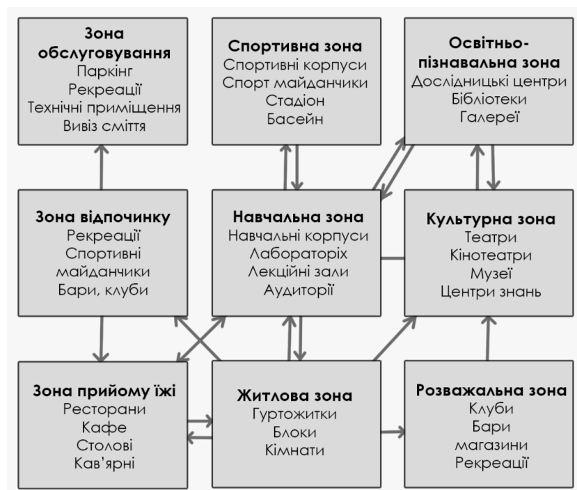
Рис. 3.3. Функціональні зв'язки між зонами генерального плану
