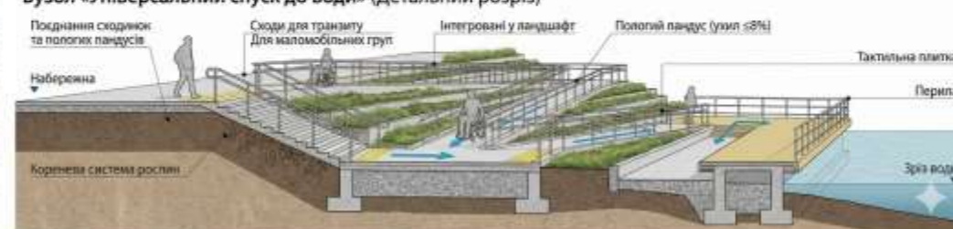
Вузол «Універсальний спуск до води» (Детальний розріз)
