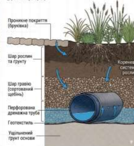
2. Конструктивна схема дощового саду / біодренажу (Деталь-розріз)
