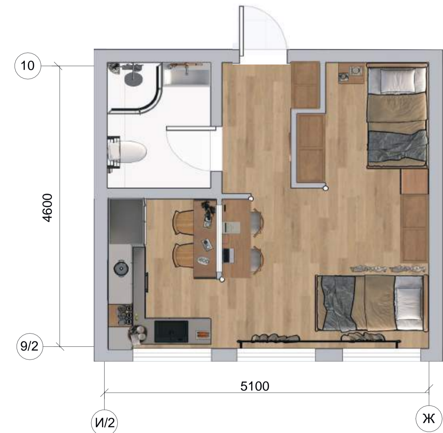
ПЛАН ПІДЛОГИ З РОЗСТАНОВКОЮ МЕБЛЮВАННЯ М 1:50
