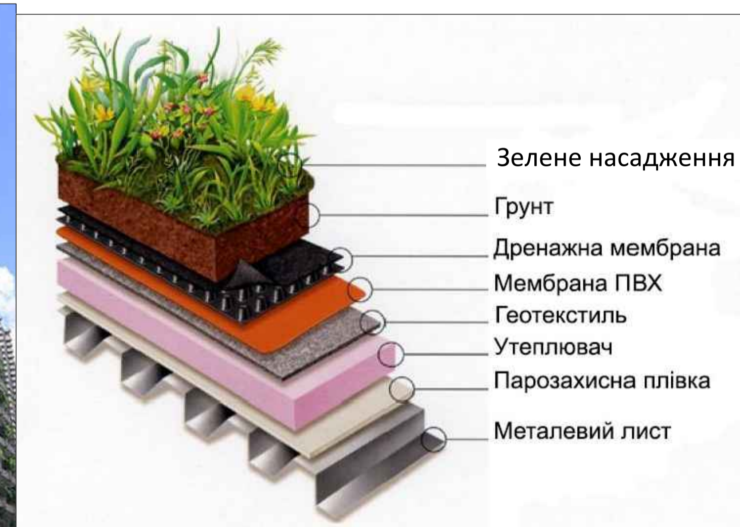
Конструкція зеленого даху
