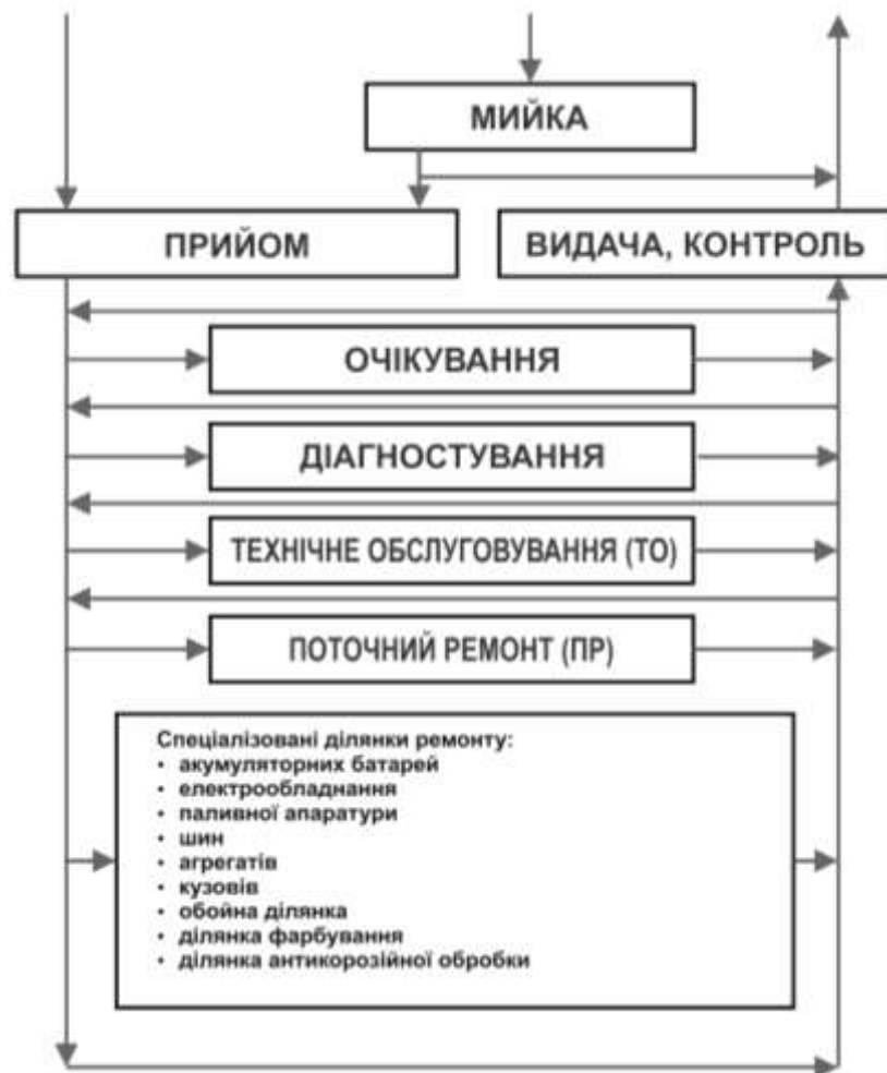
Рис. 3. Принципова схема СТО
