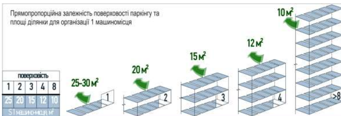
Рис.2. Прямопропорційна залежність поверховості паркінгу та площі ділянки для організації 1 машиномісця (за матеріалами Кисіль С.С.)
