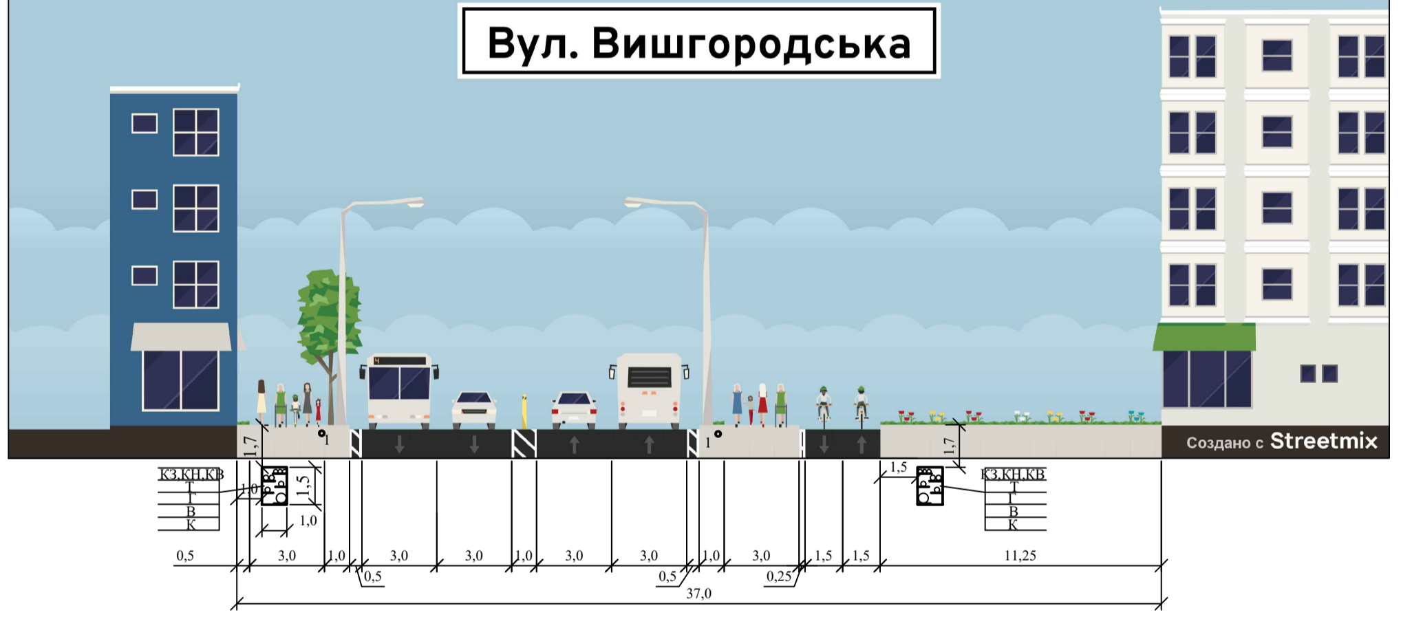
Типовий проектний профіль (Розріз 3-3)
