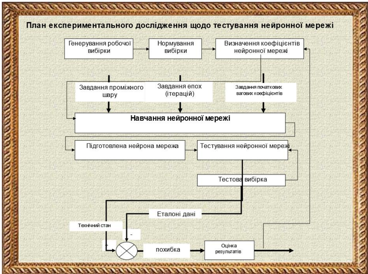
Слайд 18 – План експериментального дослідження щодо тестування нейронної мережі
