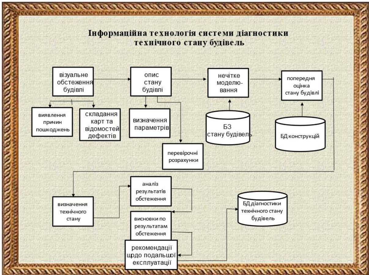
Слайд 6 – Інформаційна технологія системи діагностики технічного стану будівель
