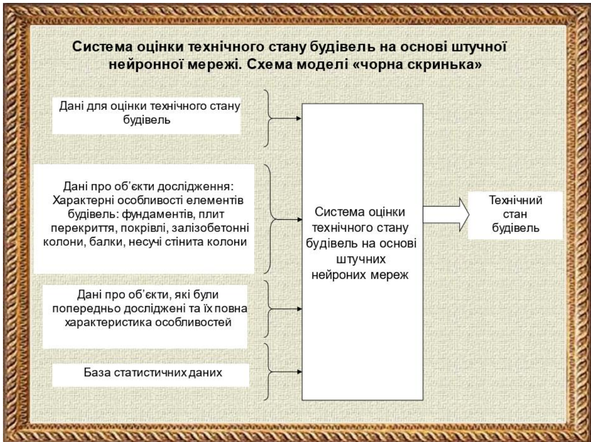
Слайд 14 – Системи оцінки технічного стану будівель на основі штучної нейронної мережі. Схема моделі «чорна скринька»
