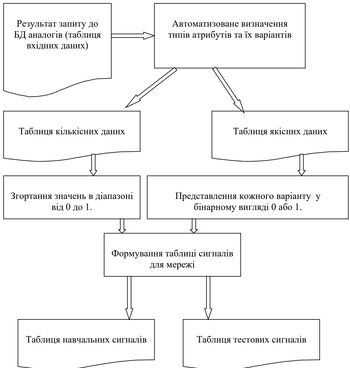
Рисунок 5.3 Підсистема підготовки інформації щодо тестування нейронної мережі
