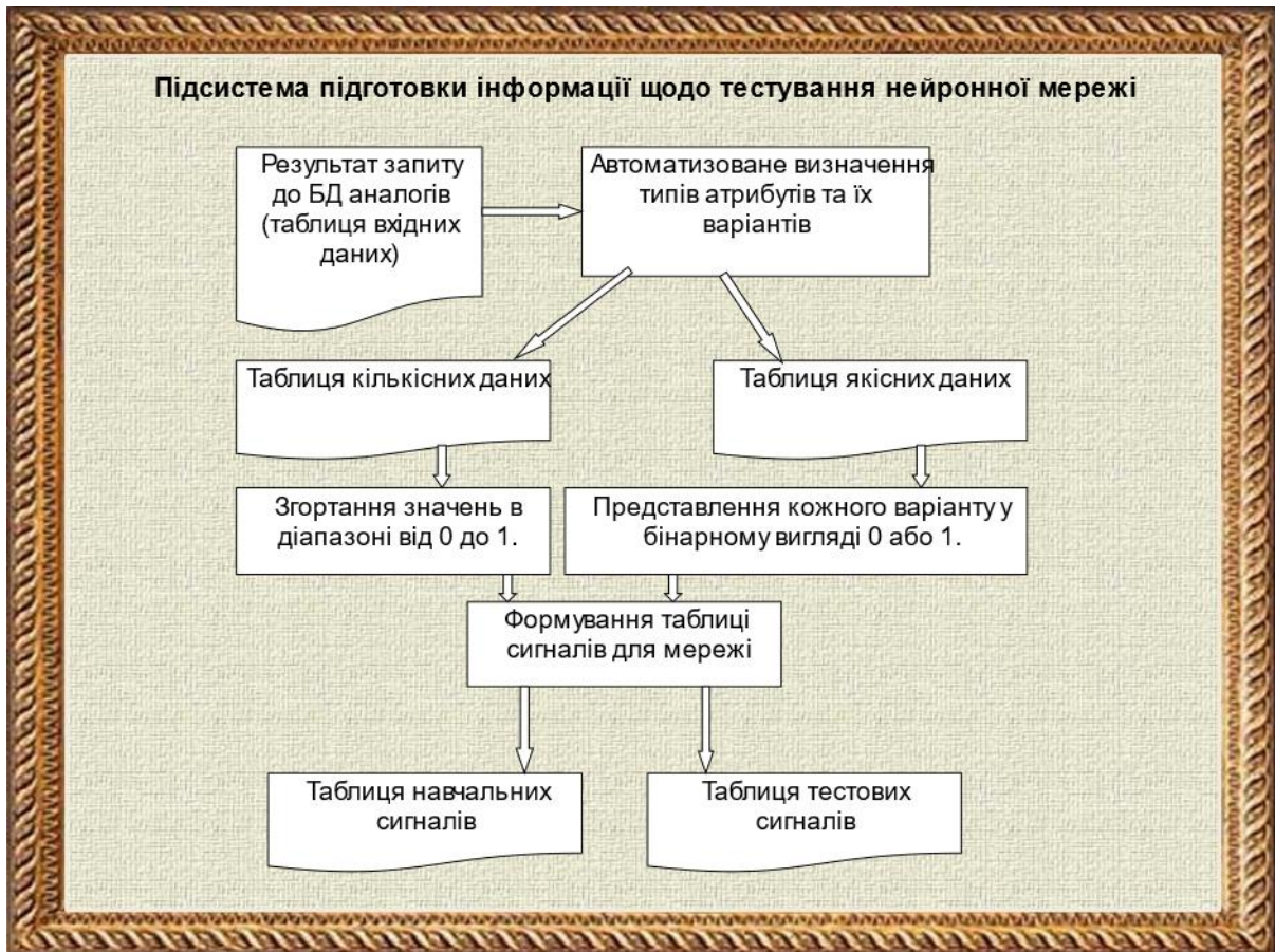
Слайд 17 – Підсистема підготовки інформації щодо тестування нейронної мережі
