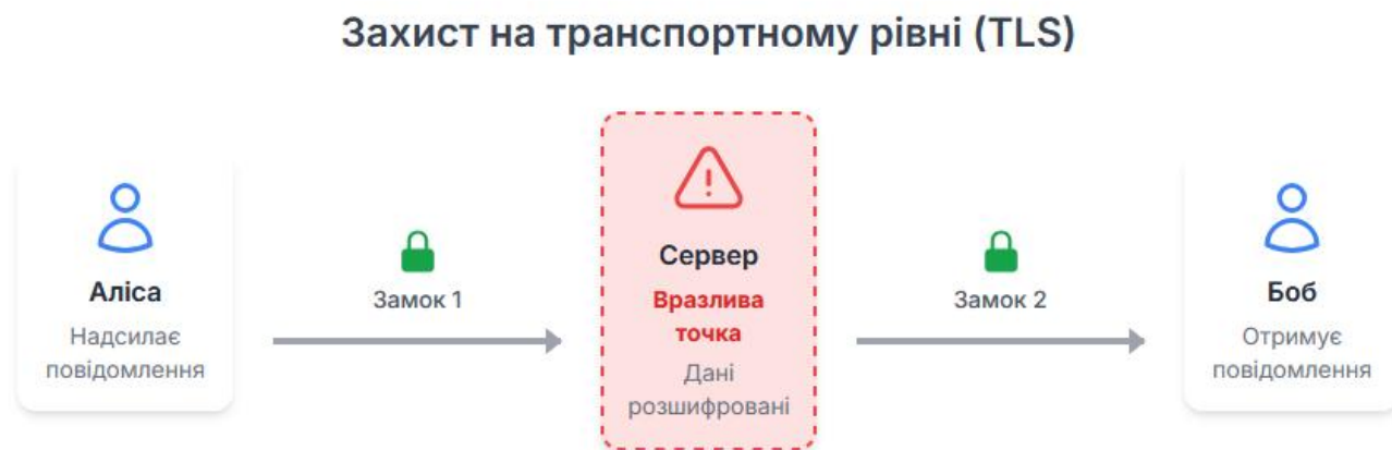
Рисунок 1.2 — Схема шифрування в TLS
