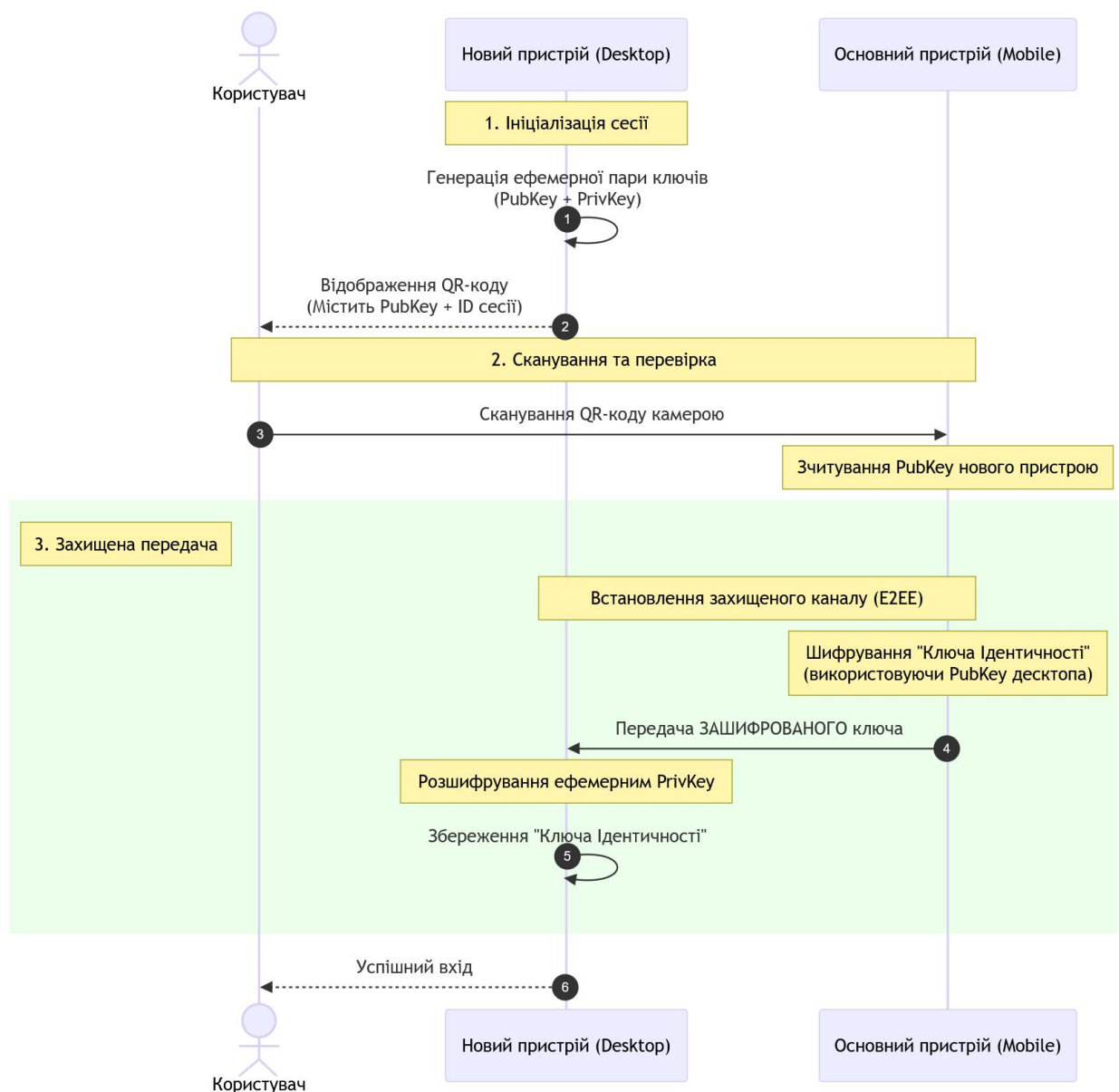
Рисунок 3.2 — Алгоритм прив'язки через QR-код
