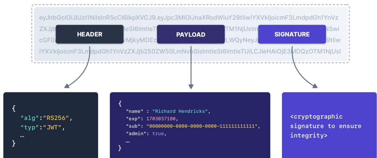
Рисунок 2.5 — Структура JSON Web Tokens (JWT)
