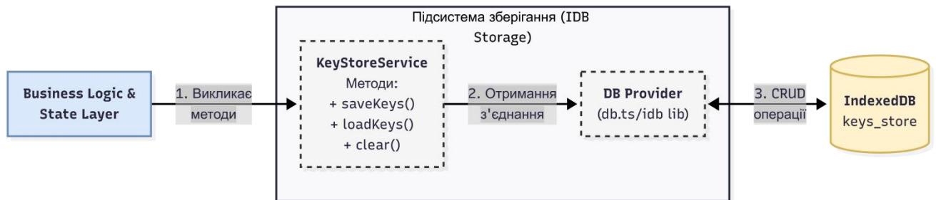
Рисунок 3.18 — Схема використання сховища ключів
