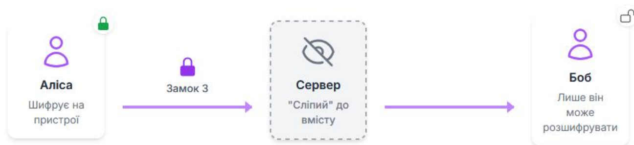
Рисунок 1.3 — Схема наскрізного шифрування
