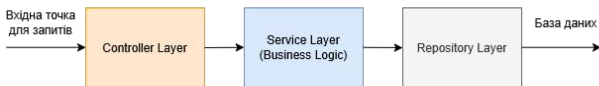
Рисунок 3.10 — Архітектура серверної частини
