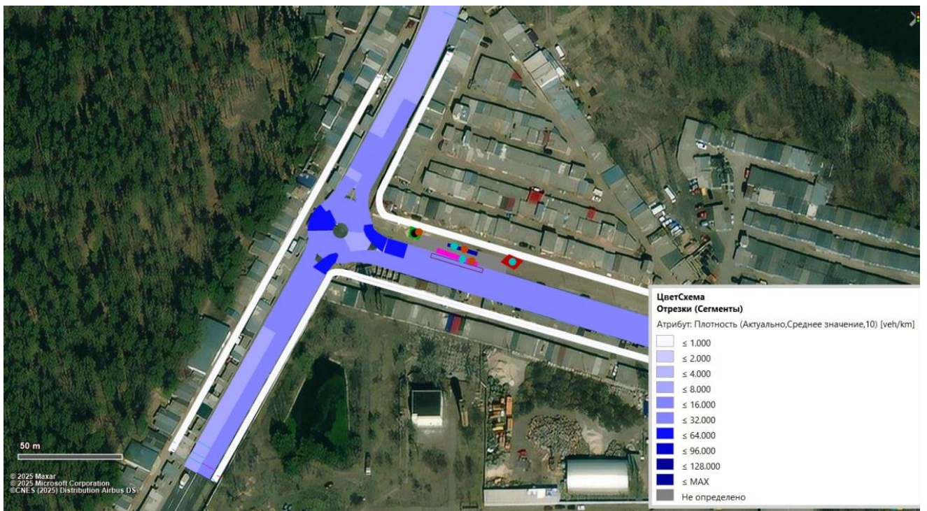
Рис. 3.6. Картограмма розподілу щільності транспортного потоку для варіанту 1
