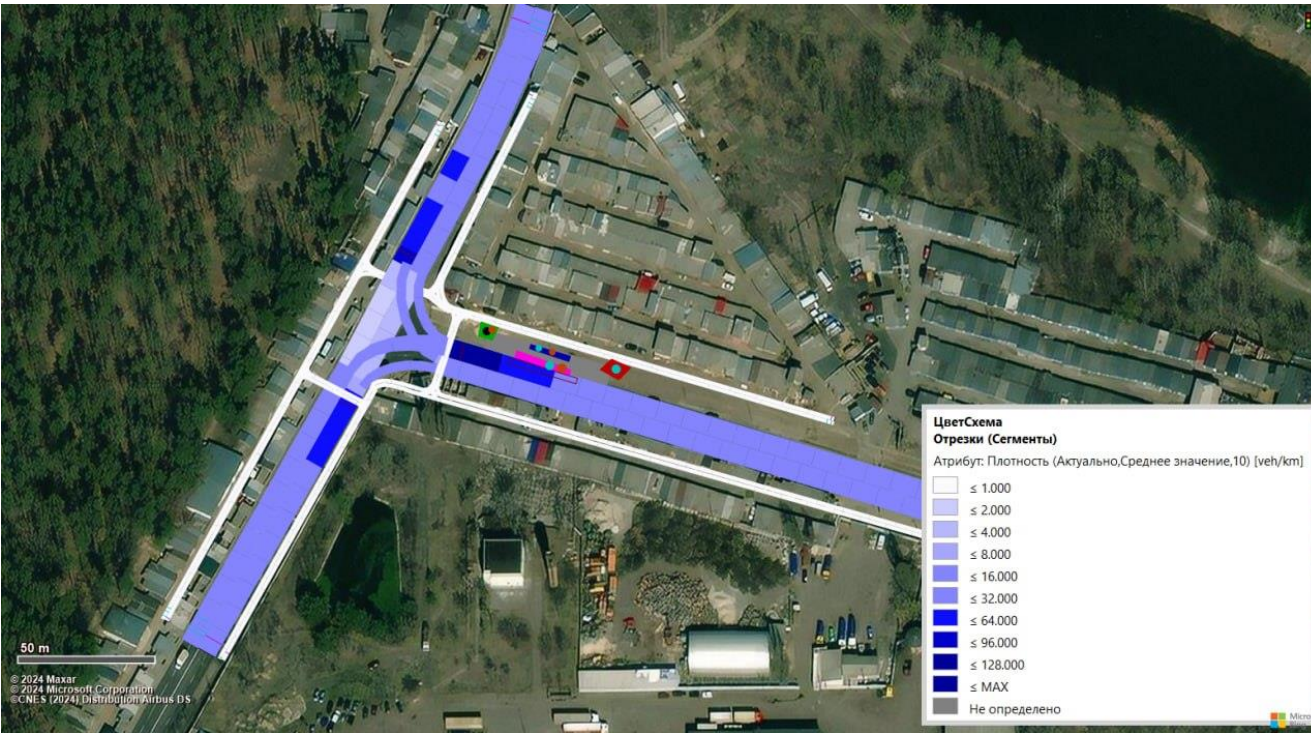
Рис. 3.9. Картограма розподілу щільності транспортного потоку для варіанта 2
