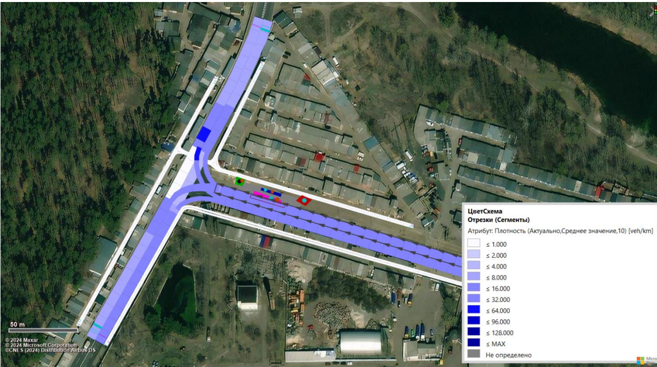
Рис. 2.8. Картограмма розподілу щільності транспортного потоку
