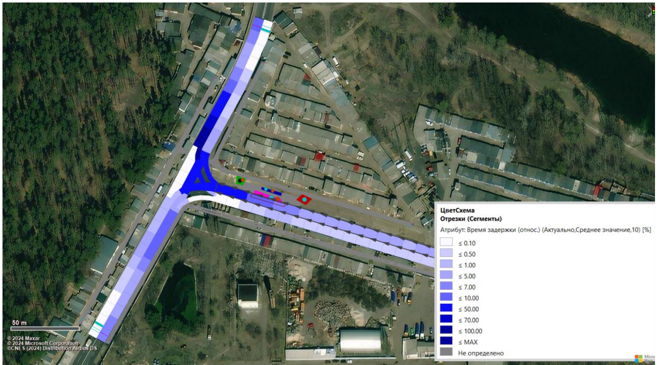
Рис. 2.9. Картограма відносних затримок транспортного потоку
