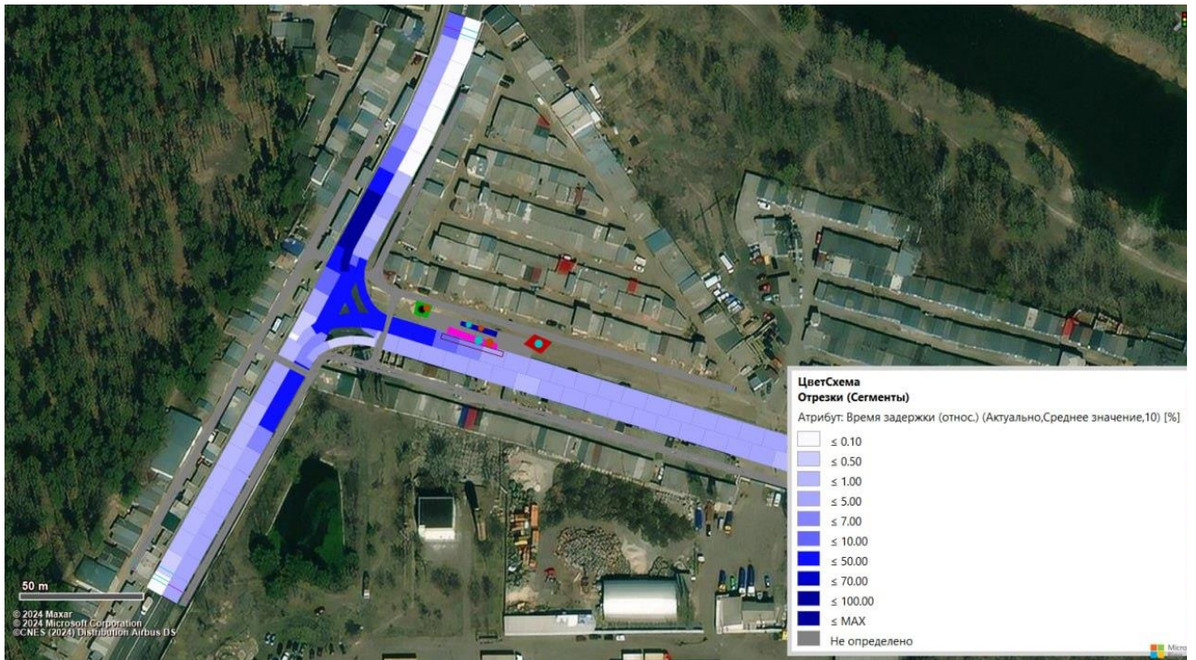
Рис. 3.10. Картограма розподілу затримок транспортного потоку для варіанта 2
