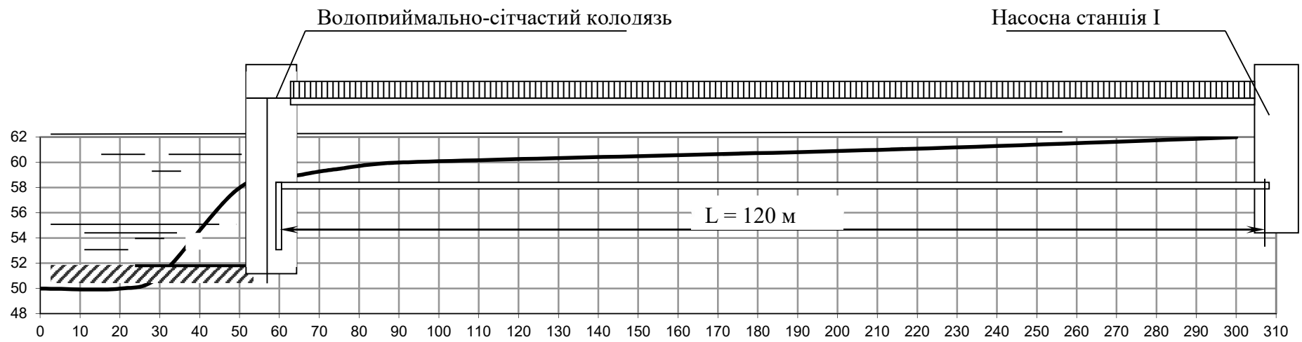
Рис.9 Схема до визначення типу водозабору та довжини водоводів
