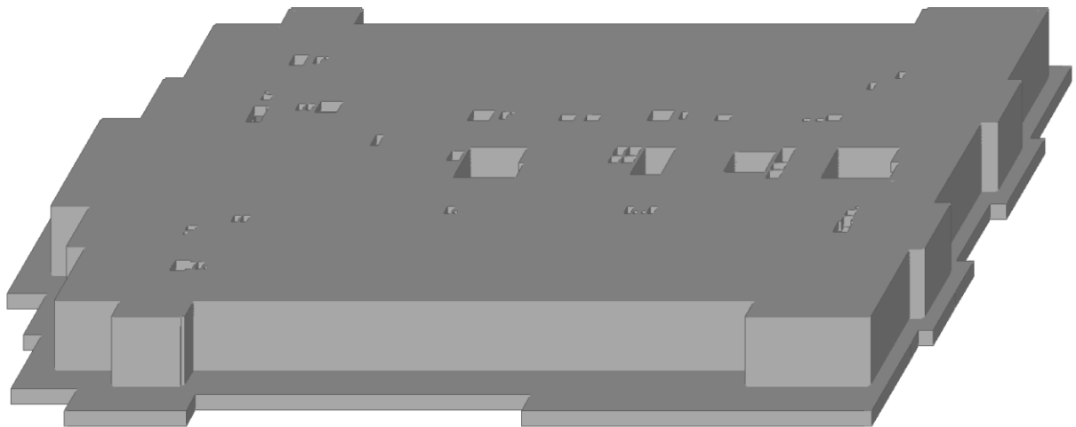
Рис. 4.21 3-Д модель цокольного поверху з плитою перекриттям
