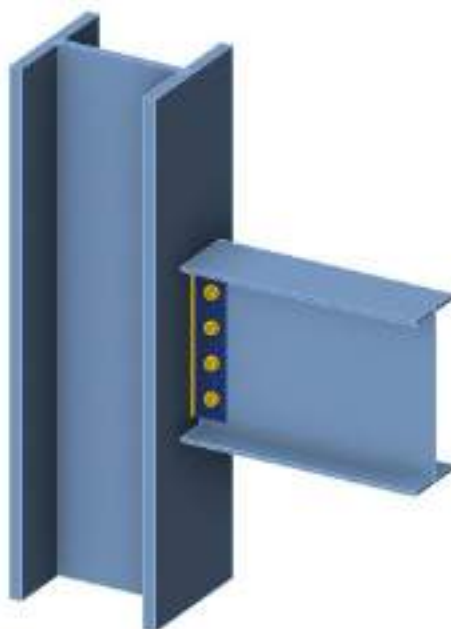
Рис. 3.3 Візуалізація вузла з'єднання ГБ та К в ПК Idea Statica Головна балка – 50Б1, Колона – 40К5
