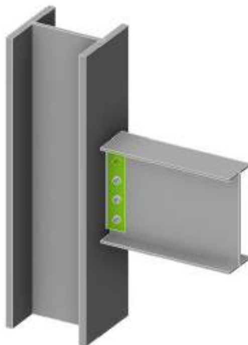
Рис.3.6 Результати розрахунку вузла в ПК Idea Statica
