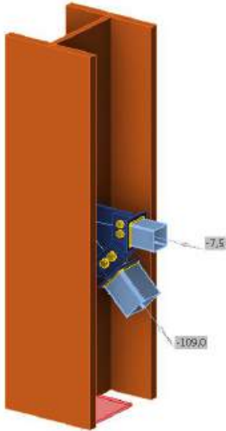
Рис. 3.34 Зусилля в елементах вузла в ПК Idea Statica
