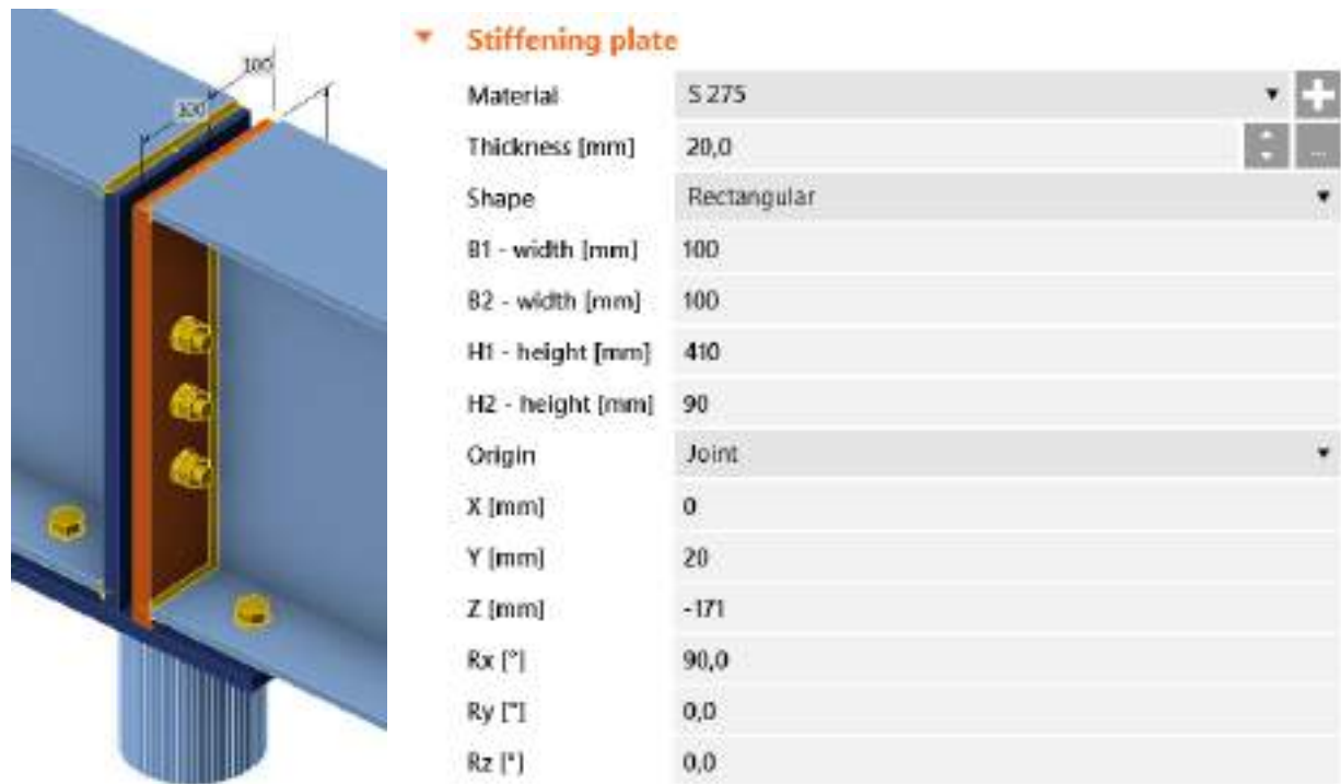
Рис. 3.13 Характеристика з'єднувальних пластин головних балок в ПК Idea Statica
