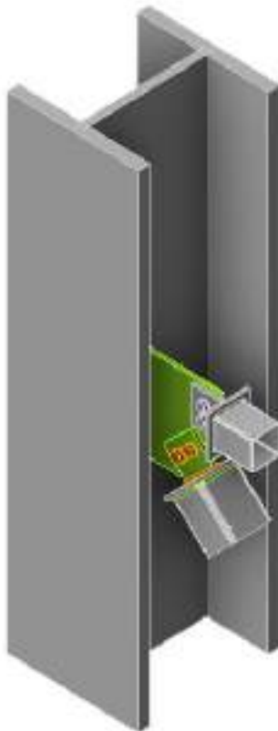
Рис. 3.35 Результати розрахунку вузла з'єднання хрестових в'язей в ПК Idea Statica
