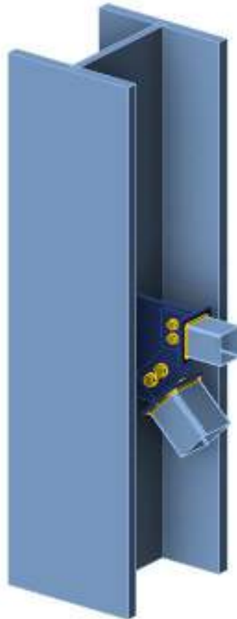
Рис. 3.30 Візуалізація вузла з'єднання хрестових в'язей з колоною в ПК Idea Statica
