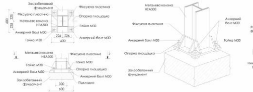
Вид з кріплення колона до фундаменту 1, М 1:10
