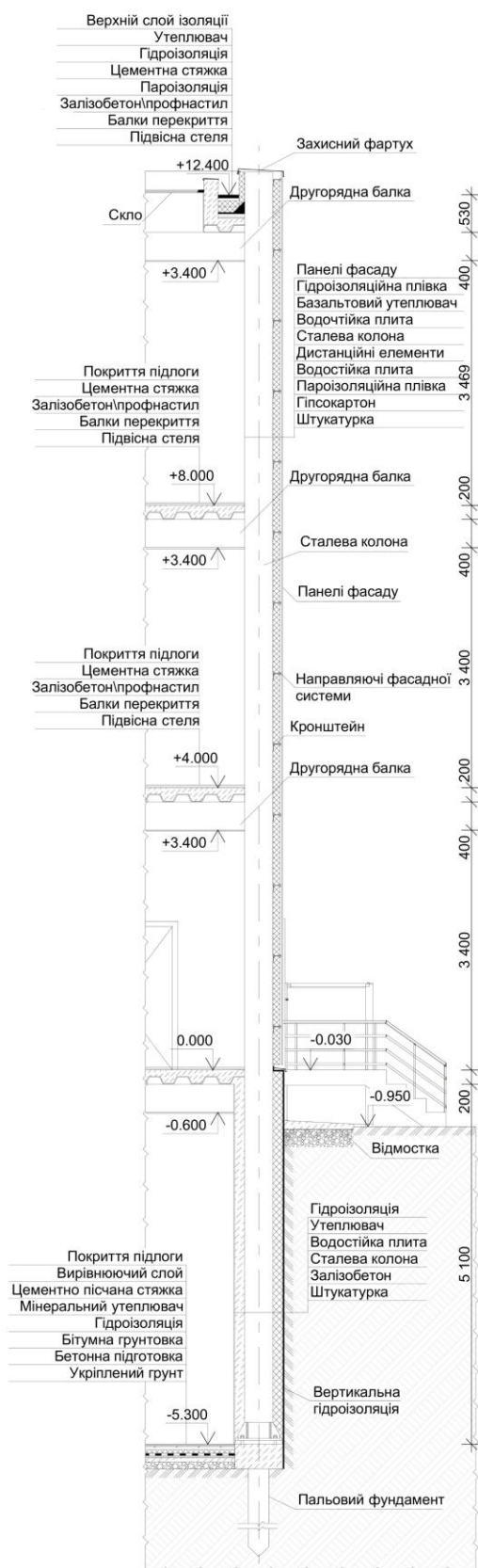
Рис. 1.4 Конструктивний розріз по стіні
