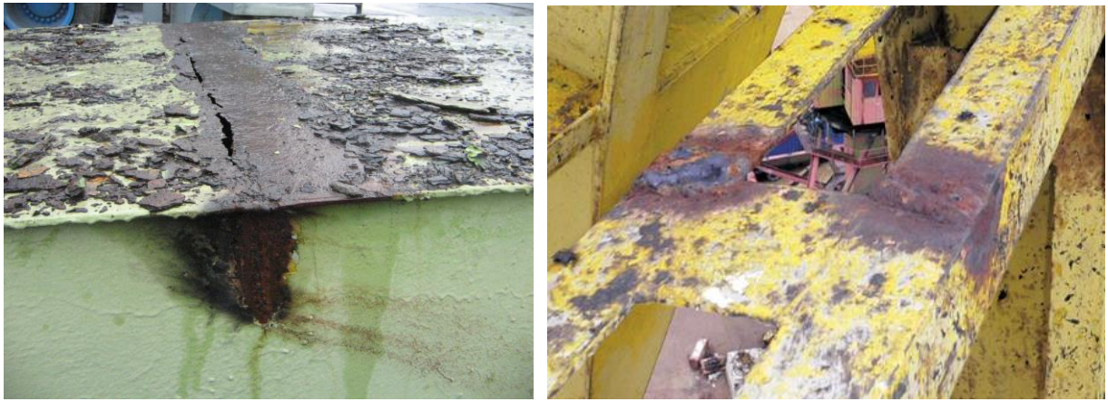
Рис. 1.18. Руйнування стріли крана: а) втомлене руйнування у місцях стикування листів; б) руйнування оголовка стріли.
