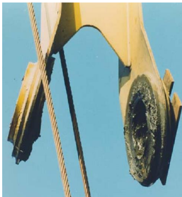
Рис. 1.15. Зруйнований шарнір «тяга коромисла–стріла».
