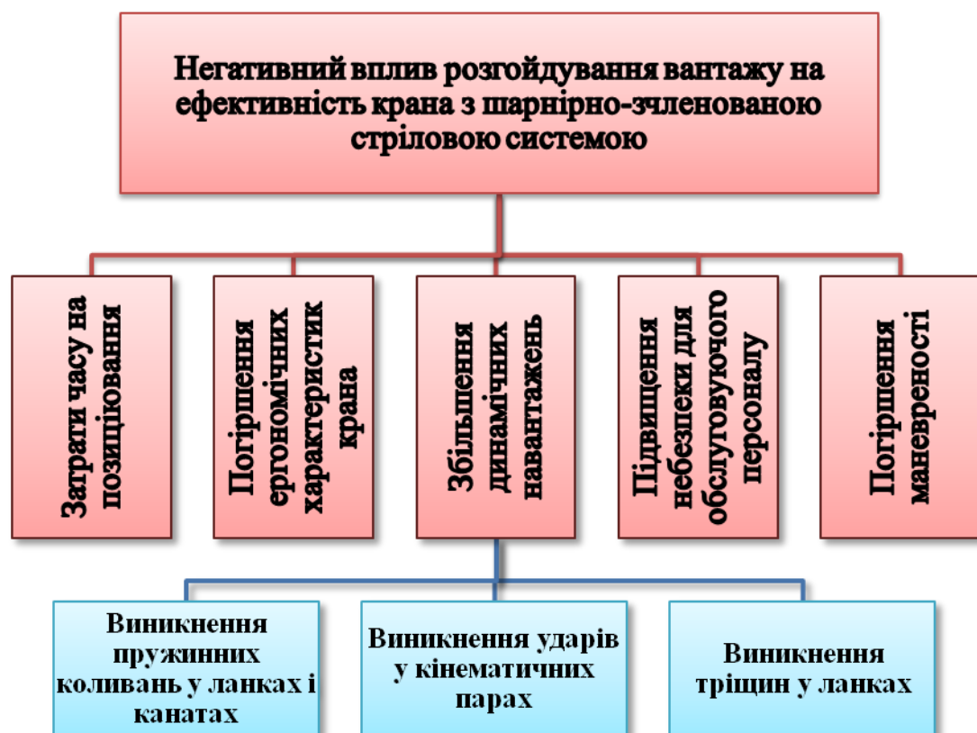
Рис. 1.14. Фактори негативного впливу розгойдування вантажу на ефективність крана із шарнірно-зчленованою стріловою системою.
