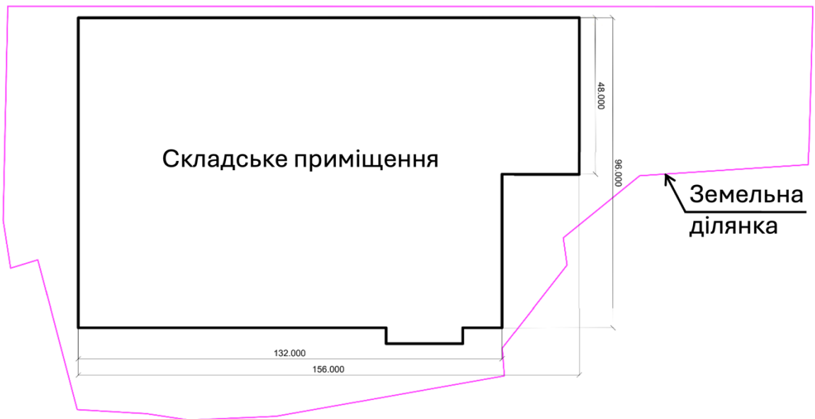
Рис. 1.1.2 Розміри на плані складського приміщення
