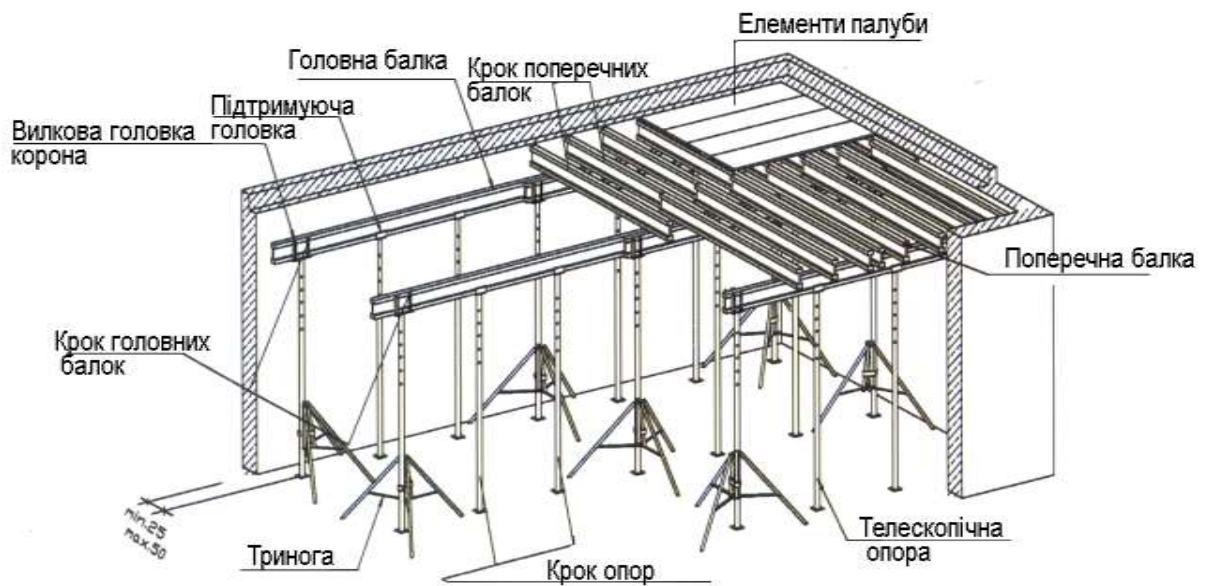
Рис. 1. Схема влаштування дрібно-, крупнощитової опалубки
