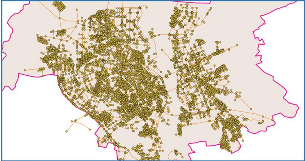
Рис. 3.6. Фрагмент електронної карти вузлів топологічної моделі ВДМ із таблиці streets_vertices_pgr та ділянок геометричної моделі сегментів ВДМ із таблиці street для м. Києва
