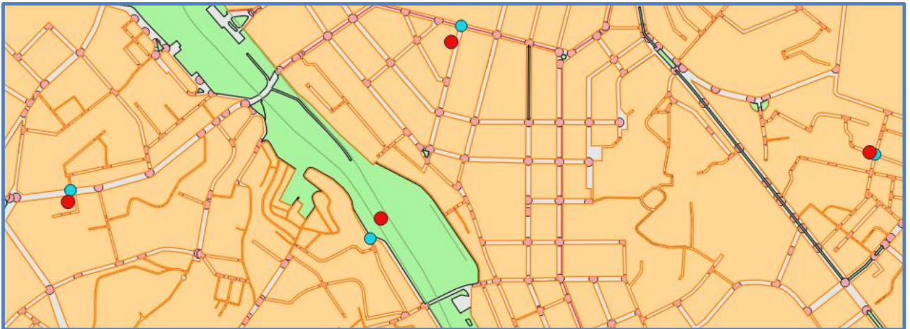
Рис. 3.7. Приклад фрагменту е-карти для контрольної візуалізації результату запиту виду з пошуку вузлів ВДМ (маркери зеленого кольору), найближчих до точок дислокації підрозділів пожежно-рятувальної служби м. Києва (маркери червоного кольору)
