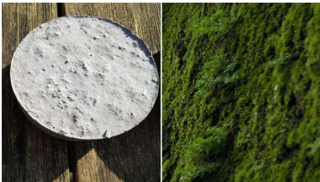
Рис. 2.2.7. Зразок бетону, що наділений розчином для росту моху [67]
