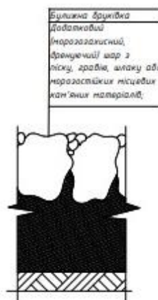
Конструкція одягу тротуару
