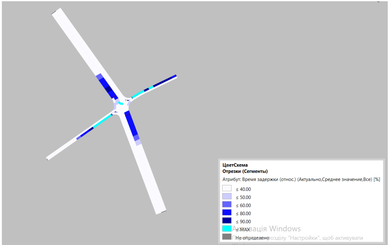
Рис. Б.3 Теплова карта «Час затримки», перетин вул. Солом’янська – вул. М. Кривоноса
