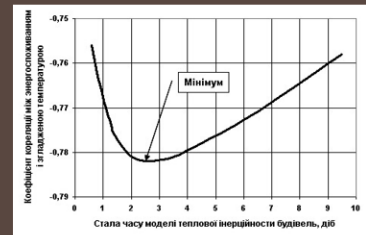
Залежність коефіцієнту кореляції між енергоспоживанням і згладженою температурою від шуканої сталої часу теплової інерційності будови
