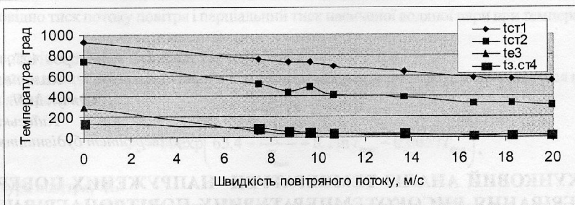
Рис. 2. Зміна температури нагрітої сталеві пластинки від швидкості повітряного потоку
