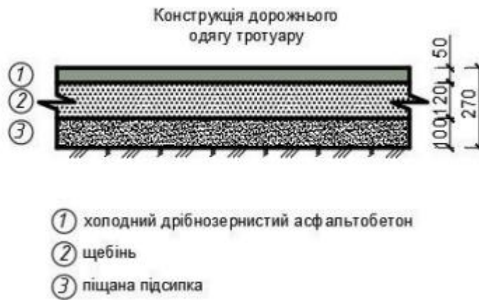
Рис. 3.2. Конструкція дорожнього одягу тротуару
