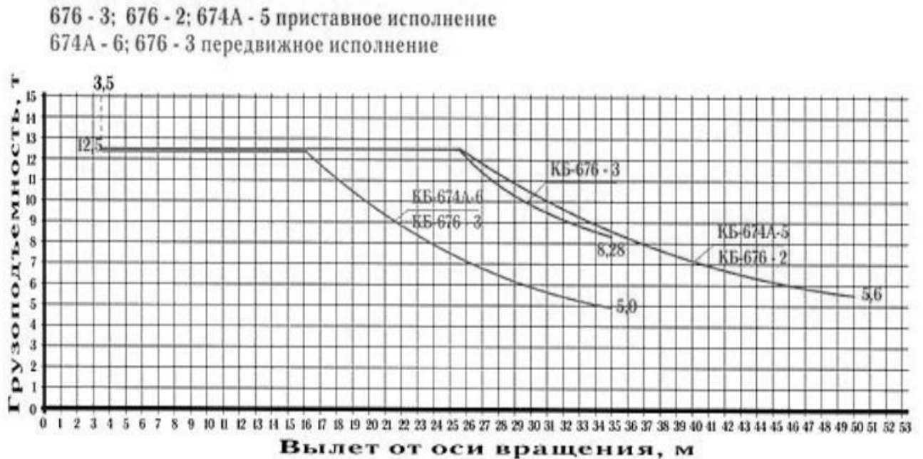
Рисунок 4.3. Вантажні характеристики крану КБ674А – 3
