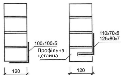
Рис. 4.43. Перемички зі сталевих кутиків:
