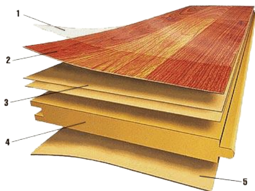
Рис. 5.26. Структура ламінованої планки:
