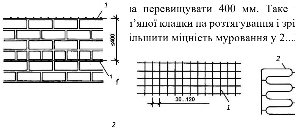
Рис. 4.26. Поперечне армування кам'яної кладки сітками: 1 – сітка з квадратними чарунками; 2 – сітка типу «зигзаг»
