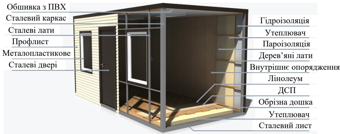
Рис. 1.21. Конструктивне рішення об'ємного блока блок-контейнера побутового приміщення зі сталевим каркасом і багатшаровими стінами
