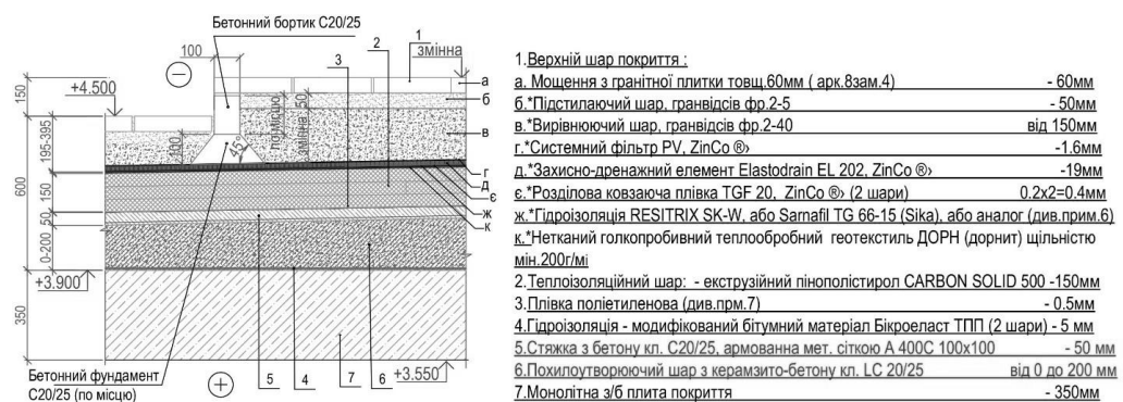
Рис. 3.19 Плита покриття паркінгу
