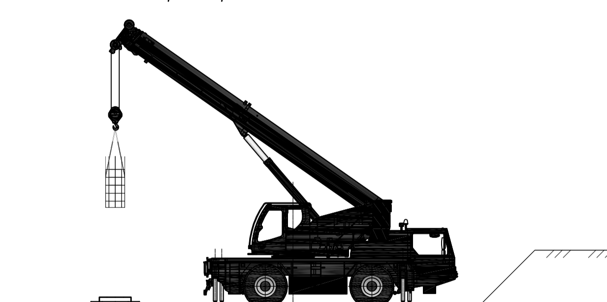
Установка армокаркаса підколонника
