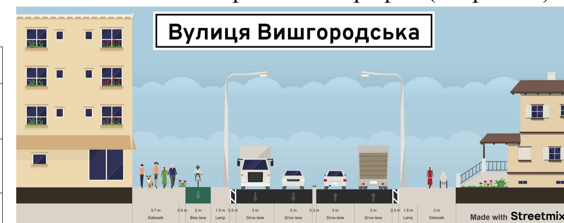
Типовий проектний профіль (Розріз 2)
