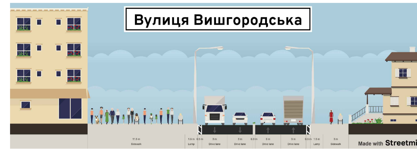
Типовий проектний профіль(Розріз 2)
