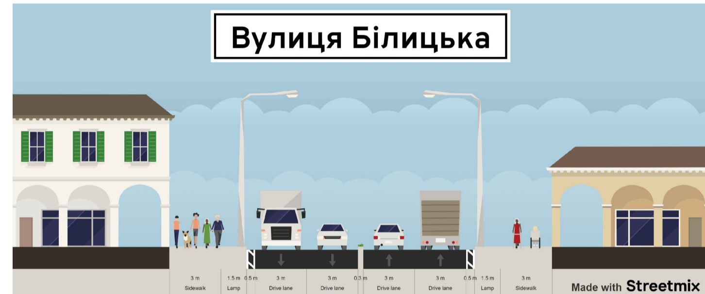
Типовий проектний профіль(Розріз 3-1)
