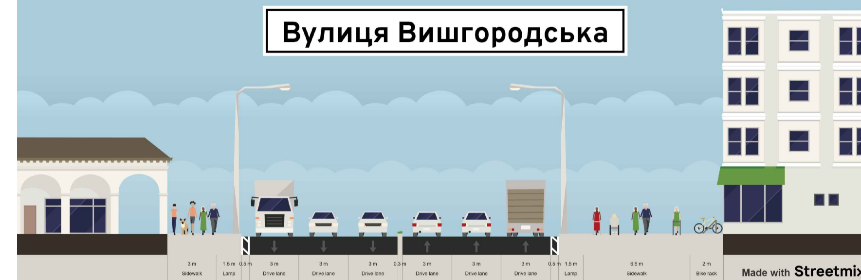
Типовий проектний профіль(Розріз 3-1)
