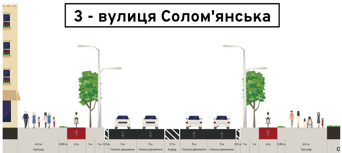
Рис. 3.7 Проектний поперечний профіль вул. Солом'янська
