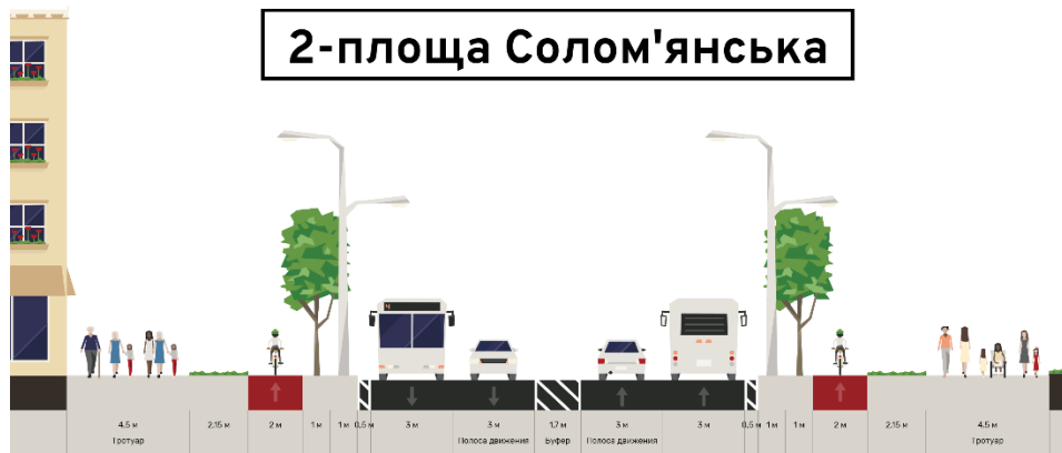
Рис. 3.6 Проектний поперечний профіль площі Солом'янська
