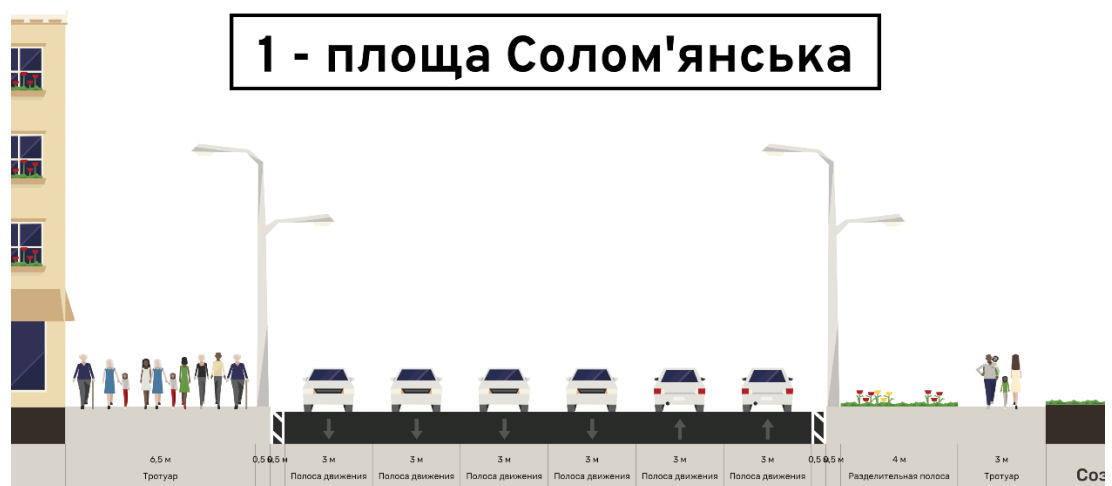
Рис.3.2 Існуючий поперечний профіль площа Солом'янська
