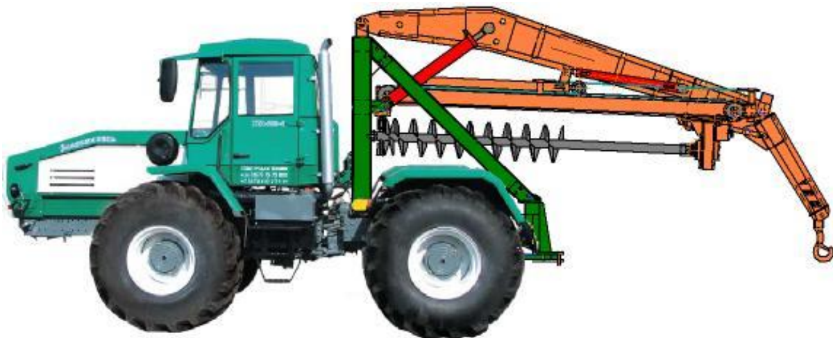
Рис. 1.3 Бурильно-кранова машина БKM-3У на базі Т-150
