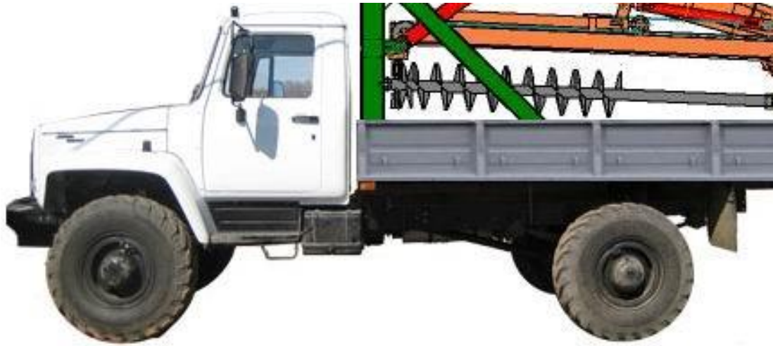
Рис. 1.4 Бурильно-кранова машина БКМ-3У на базі ГАЗ-3308
