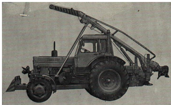
Рис. 1.8 Машина бурильно-кранова БМ- 205 на базі МТЗ-82Л
