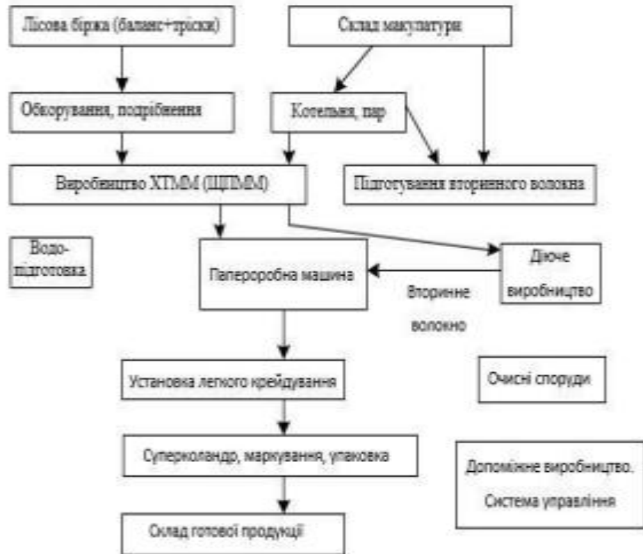
Рисунок 1.7 – Технологічний процес переробки макулатури
