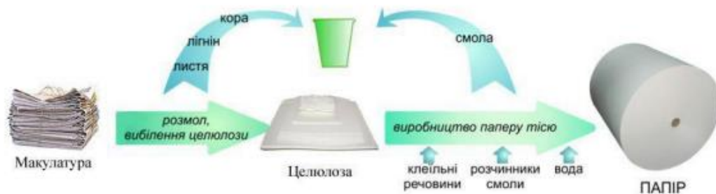
Рисунок 1.3 – Схема технологічного процесу виробництва паперу (картону).
