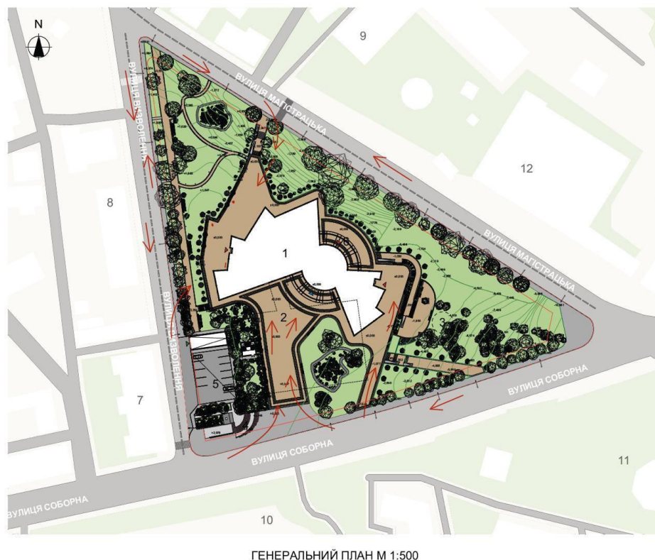
Рис. 8.2.1. Схема руху пожежної машини
