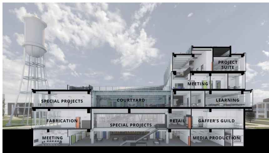
Рис 2.9. Iowa State University Student Innovation Center, в Еймсі, арх. К. Тімберлейк, 2021 р.: розріз [3]
