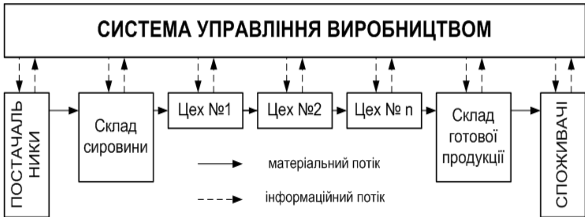
Рис. 5. «Штовхаюча» система управління матеріальним потоком
