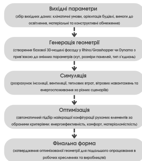
Рисунок 1. Алгоритмічна схема роботи параметричної моделі для проєктування кінетичного фасаду(авторська ілюстрація, 2025).
