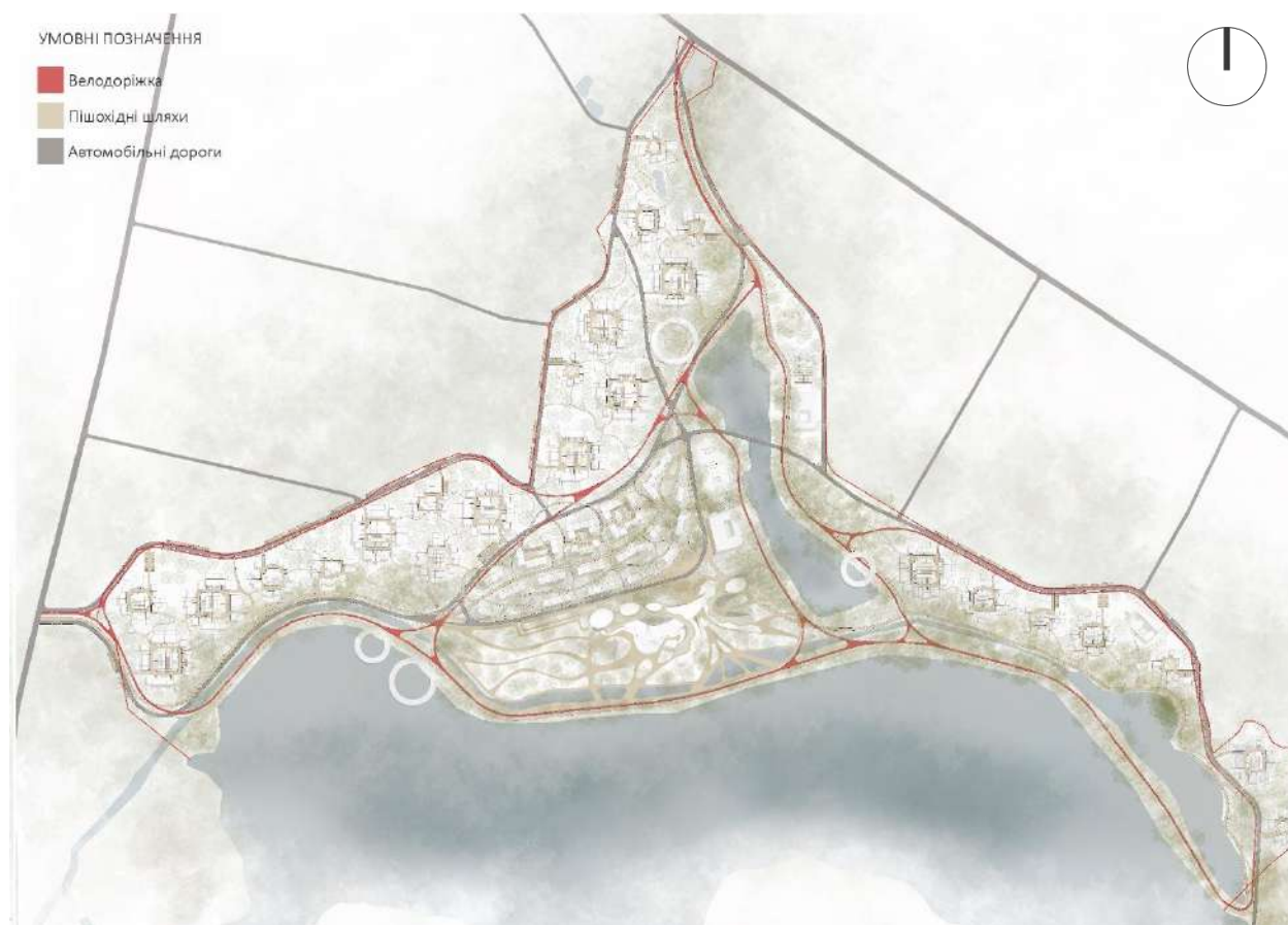
Рис. 3.8. Транспортно-пішохідна схема екопоселення
