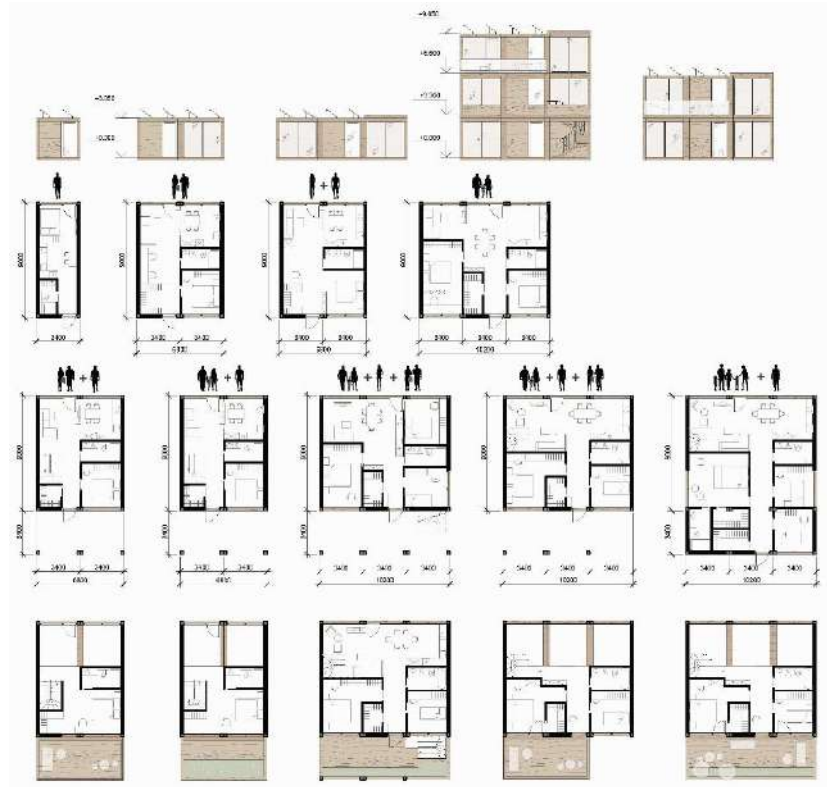
Рис. 3.19. Типи блочних житлових модулів
