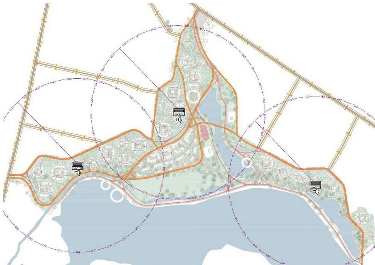
Рис. 4.3. Схема інженерно-технічних заходів цивільного захисту екопоселення з нанесенням евакуації населення у випадку надзвичайної ситуації, що потребує укриття в СПП з властивостями ПРУ та магістралей сталого функціонування
