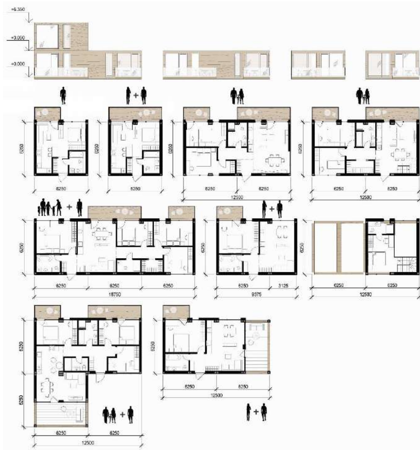
Рис. 3.20. Типи збірних житлових модулів
