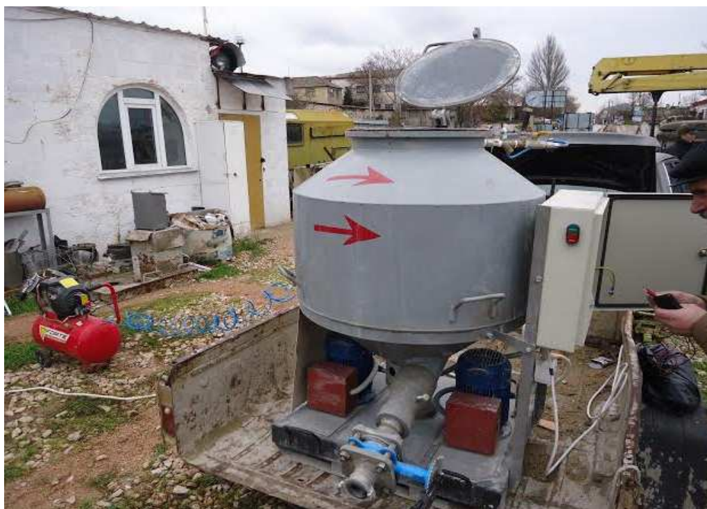
Рис. 2. Модифицированный поробетоносмеситель СПБУ-4
