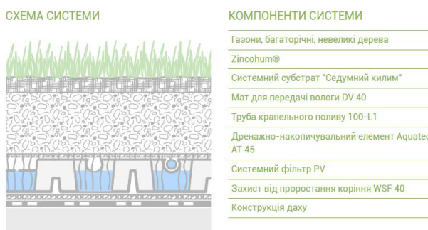
Рис.6.3. Схема системи інтенсивного даху від компанії Zinco
