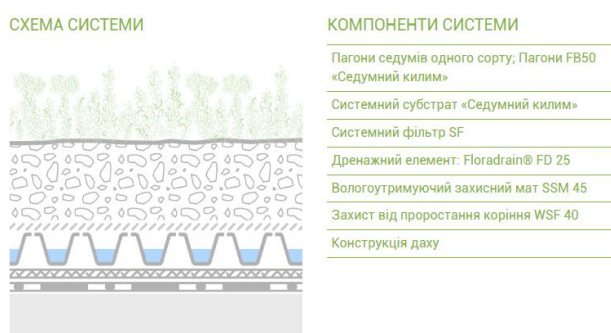
Рис.6.1. Схема системи екстенсивного даху від компанії Zinco
