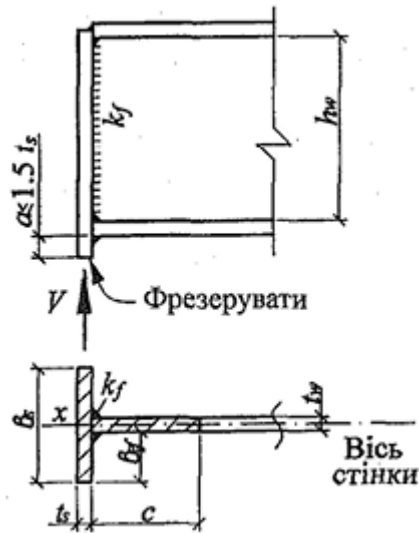
Рис.3 До розрахунку торцевого опорного ребра.
