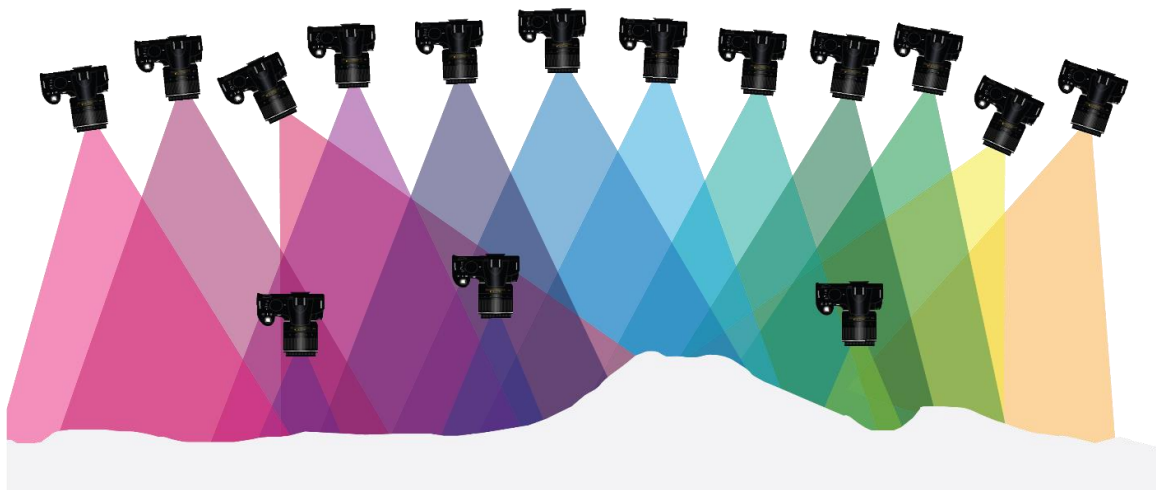
Рис. 3.4. Фотографії збігаються на об'єкті, під різними відстанями та кутами
