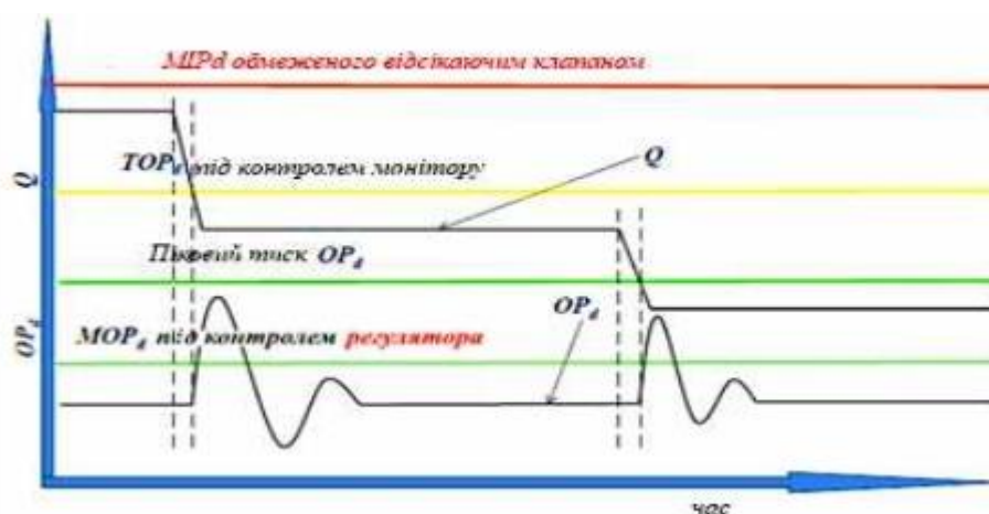
Рис. 1.2. Зміна регульованого тиску OP < 1 при різкому зменшенні витрати газу для однієї лінії редукування при нормальних умовах роботи
