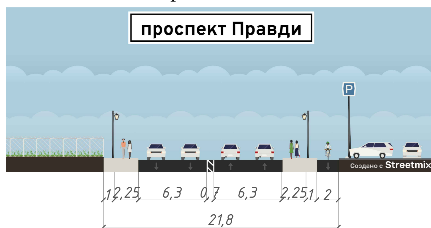
Проектний оперечний профіль просп. Правди Розріз 2-2 М 1:200
