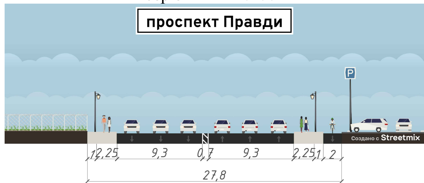
Проектний поперечний профіль просп. Правди Розріз 1-1 М 1:200
