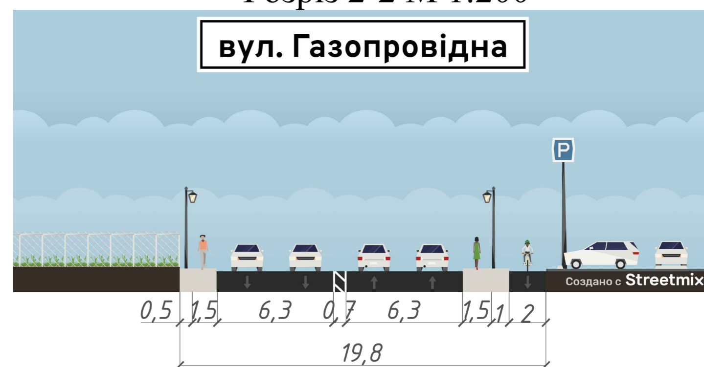
Проектний оперечний профіль вул. Газопровідна Розріз 2-2 М 1:200
