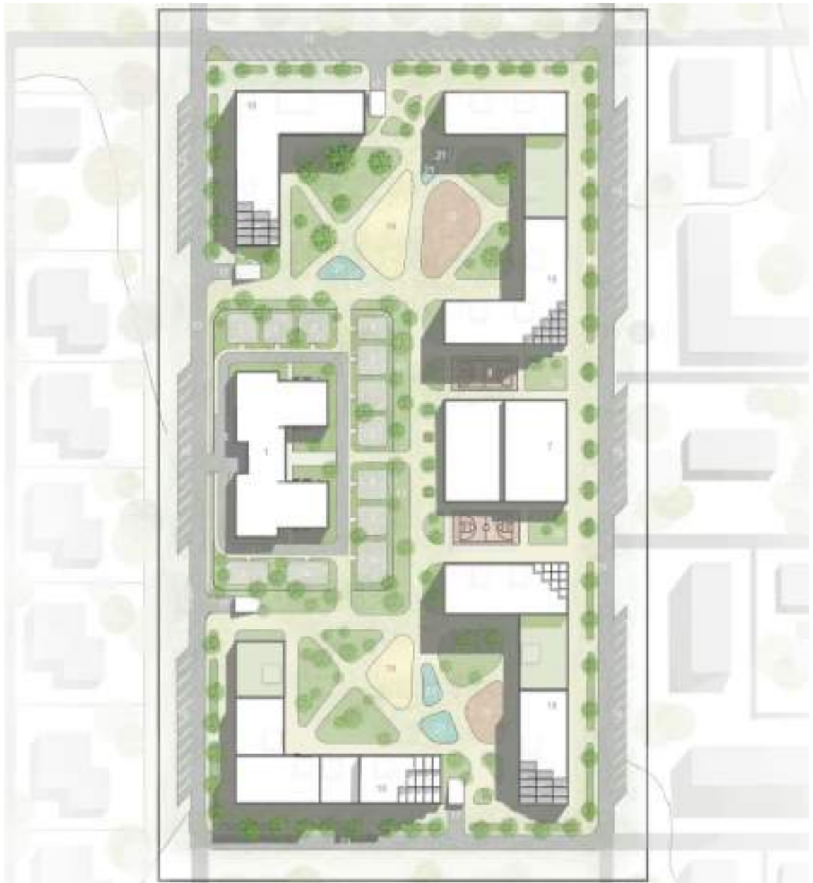
Рис.3.1.8. Генеральний план житлового комплексу : 1 — Будівля дитсадку, 2 — Ігровий майданчик для груп, 3 — Город-ягідник, 4 — Спортивний майданчик, 5 — Господарча зона, 6 — Місце для вивчення ПДР, 7 — Будівля спорткомплексу, 8 — Спортивний майданчик для баскетболу, 9 — Спортивний майданчик для волейболу, 10 — Відкритий майданчик із тренажерами, 11 — Яблунева алея, 12 — Головна дорога по вул. Леонтовича, 13 — Об'їзна дорога навколо комплексу, 14 — Гостьовий паркінг, 15 — Паркінг дитячого садка, 16 — Паркінг спортивного комплексу, 17 — Заїзд у підземний паркінг, 18 — Запроєктовані будівлі комплексу, 19 — Дитячий майданчик, 20 — Зона для відпочинку дорослих, 21 — Штучна водойма.
