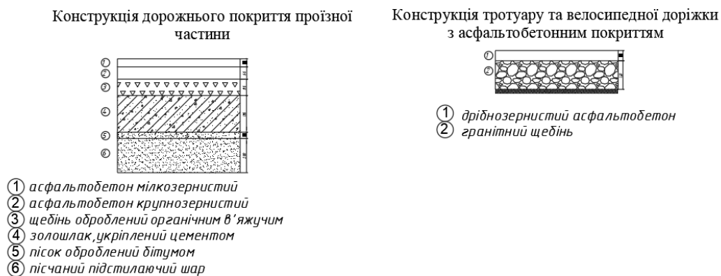
Рис. 12. Конструкція дорожнього одягу
